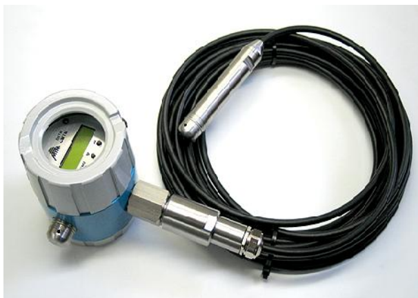
Slika 1 - Realizovan inteligentni transponder nivoa
