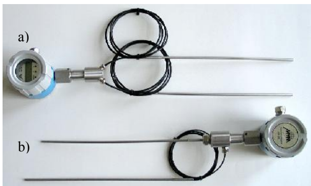
Slika 3 - Realizovan transmitter diferencije temperature: a) sa dve Pt-100 sonde na fleksibilnom kablju b) sa fiksnom Pt-100 sondom i Pt-100 sondom na fleksibilnom kablju
