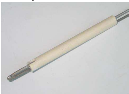
Slika 7 – Spoj termoelektroda koje čine termopar u zaštitnoj keramičkoj oblozi
