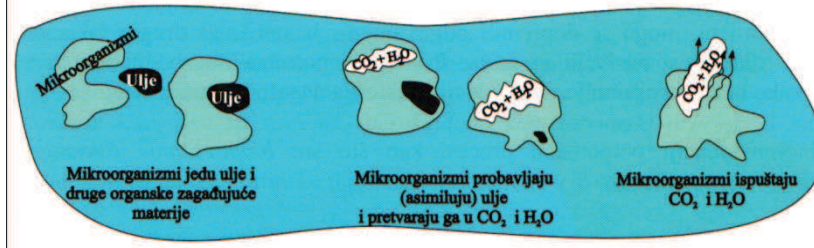
Slika 1. Mehanizam biodegradacije [3] Fig. 1 Biodegradation mechanism [3]
