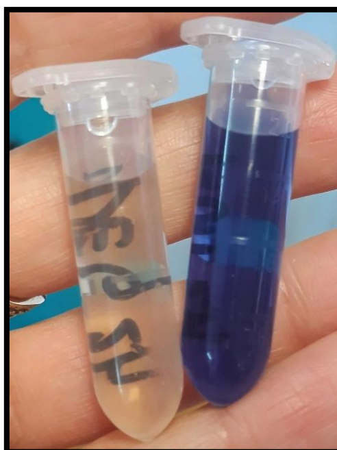
Slika 4.10. Promena boje nakon elektrohemijske dekolorizacije RB5 25 mg/L + 0,5 mM H 2 O 2 , nakon 2 h tretmana.
