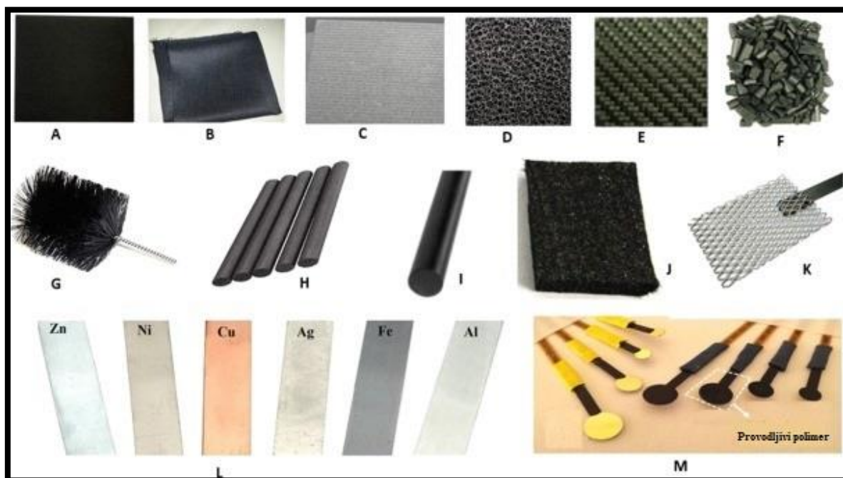
Slika 2.3. Izgled konvencionalnih materijala za izradu elektrode: (A) ugljenični papir, (B) ugljenično platno, (C) ugljenično vlakno, (D) mrežasti staklasti uljenik, (E) ugljenična mreža, (F) grafitne granule, (G) ugljenične četke, (H) grafitna šipka, (I) polikristalni grafit, (J) ugljenični filc, (K) platinasta mreža, (L) različite trake metala, (M) provodljive trake na bazi polimera (Yaqoob et al., 2020).
