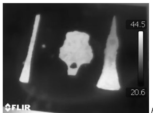
Slika 7. Metalni eksponati iz rimskog perioda, a–video snimak, b–termogram u fazi hlađenja eksponat
