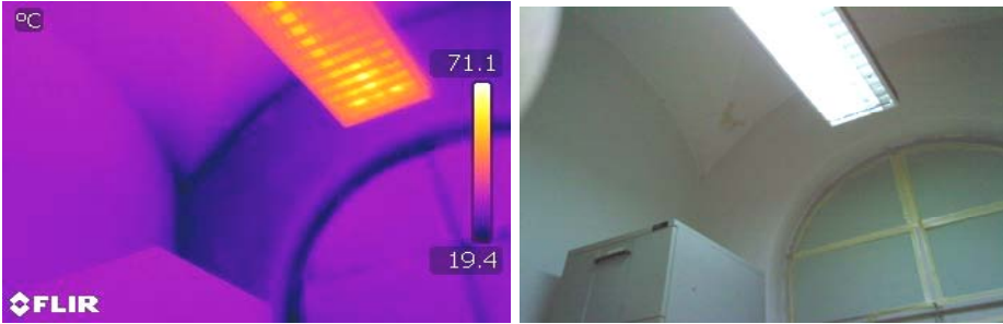
Figure 11 – Poor thermal insulation in the photo collections depot. Slika 11 – Loša termička izolacija u depou sa zbirkom fotografija
