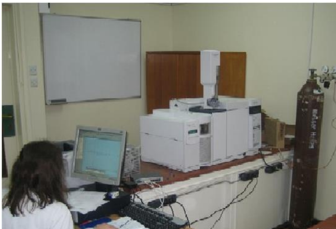
Slika 3.2. Izgled aparature za ispitivanje čistoće uzoraka ( https://ihtm.bg.ac.rs/sr/o-nama-ch/oprema-ch )
