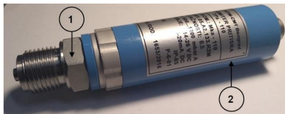
Slika 4 - Realizovan malogabaritni transponder pritiska TPa/r-110: 1) merne komora sa prelaznim fiksirajućim elementom, 2) kutija elektronike
