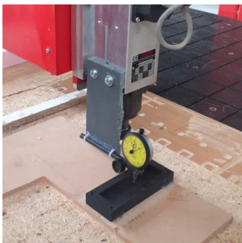
Slika 5. Merenje epruvete komparaterom uz pomoć CNC mašine
