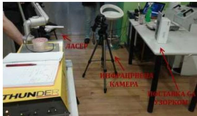
Slika 5.9 Termografska ispitivanja, a-Infracrvena kamera FLIR E40 [165],
