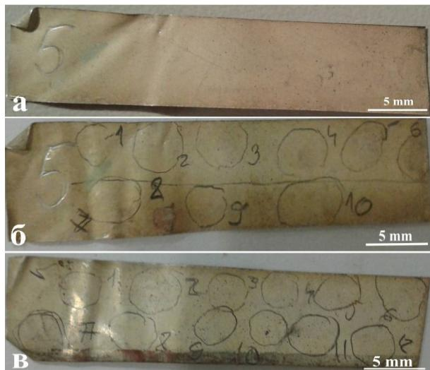
Slika 12.28 Ispitivani uzorak posrebrene bakarne pločice IGBP 4 a- pre ozračavanja, b-označene zone na licu uzorka i c-ozračene zone na naličju uzorka
