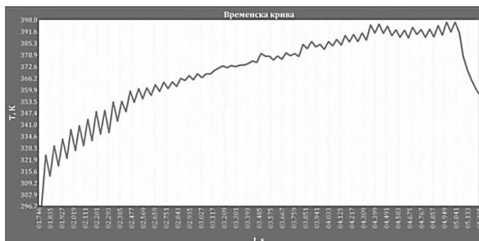
Slika 12.14 Vremenska raspodela temperature na glaziranoj površini uzorka u tački sa maksimalnim vrednostima
