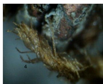
Slika 11.10 Korozioni kristali na pamučnim nitima.
