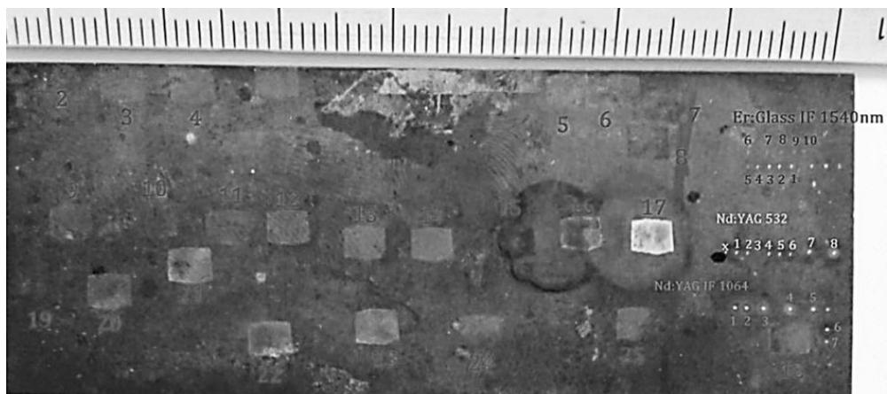
Slika 10.2 Ozračene zone na mesinganoj pločici
