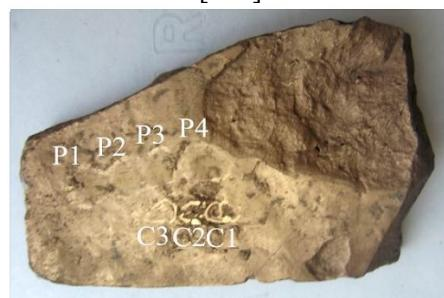
Slika 8.13 Uzorak IG 203 B pripremljen za SEM analizu
