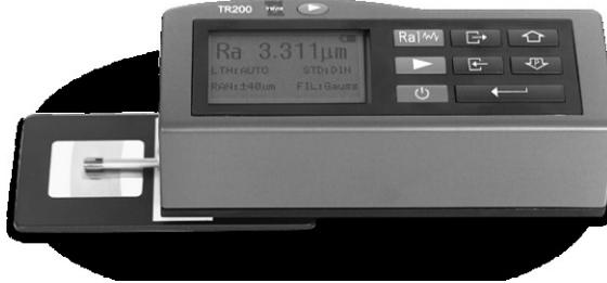
Slika 5.8 Mehanički profilometar TIME Instruments TR200 [163]
