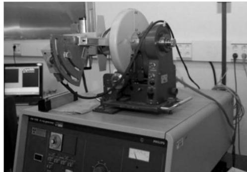
Slika 5.4 XRD uređaj marke PHILIPS PW 1710 [161]
