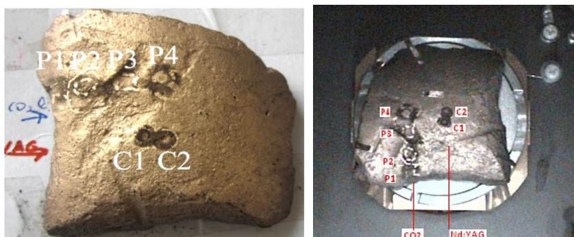
Slika 8.7 Uzorak IG 203 A pripremljen za SEM analizu
