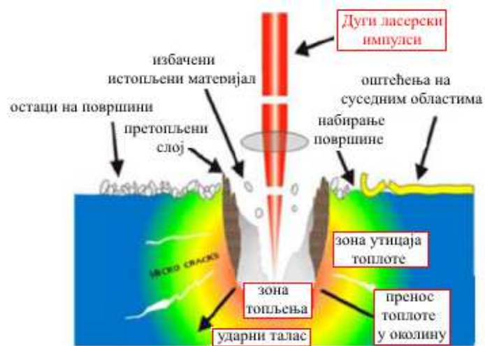
Слика 4.4: Термичка аблација: различите физичке појаве које се јављају деловањем дугих ласерских пулсева [177].
