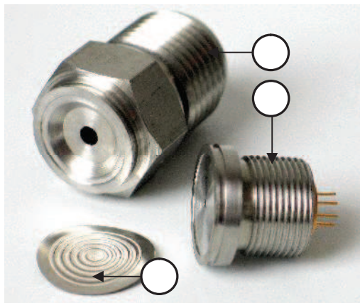
Slika 5 - Elementi transdjusera pritiska: 1) procesni priključak, 2) membrana, 3) centralna sekcija sa izvodnicama
