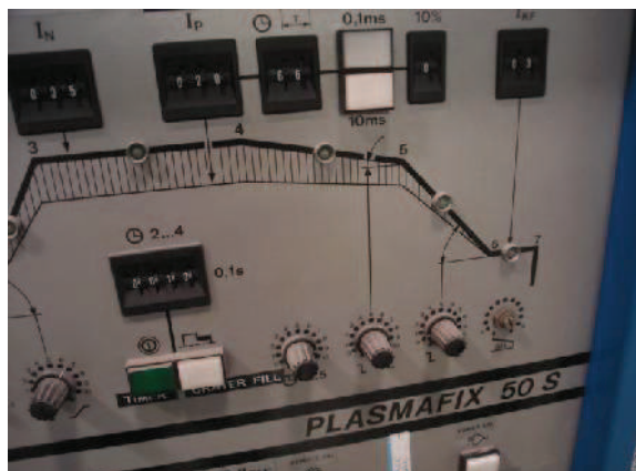
Slika 7 - Uređaj za plazma zavarivanje PLASMAFIX 50S
