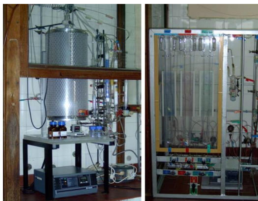
Slika 13. Konstrukcija za suhu redukciju prekursora
