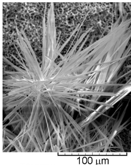
СЛИКА 4. Веома fine игле MgO/Mg(OH)_2 груписане у агрегате налик цветовима добијене електролизом из растопа [3]
