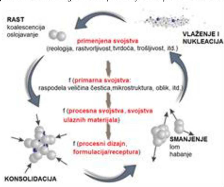
Slika 1. Mehanizmi procesa mokrog granulisanja
