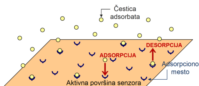
Slika 3.2 Ilustracija procesa jednoslojne adsorpcije i desorpcije čestica jedne supstance na aktivnoj površini senzora.
