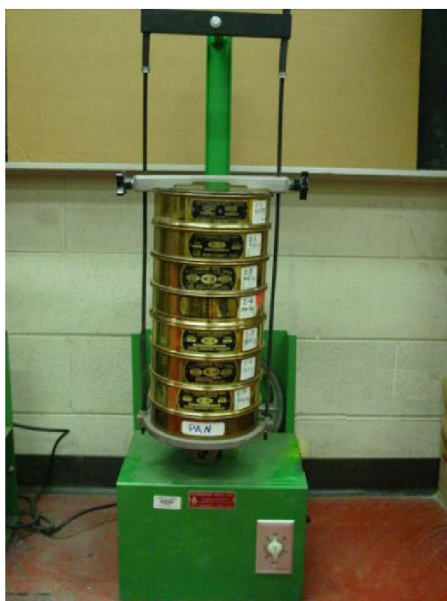
Slika 3.1 Električna tresilica za prosejavanje materijala pomoću sistema sita
