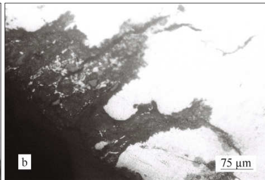
Sl. 7.13b ZA27/1%SiC, izgled površine posle 30 dana u 3,5 NaCl. OM, polirano.
