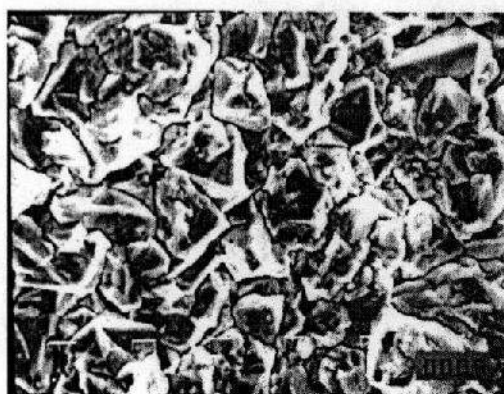
Slika 6. SEM fotografija površine galvanske prevlake Cu dobijene iz elektrolita bez dodatka za sjaj, debljine 50 \mu\text{m} . X2000.
