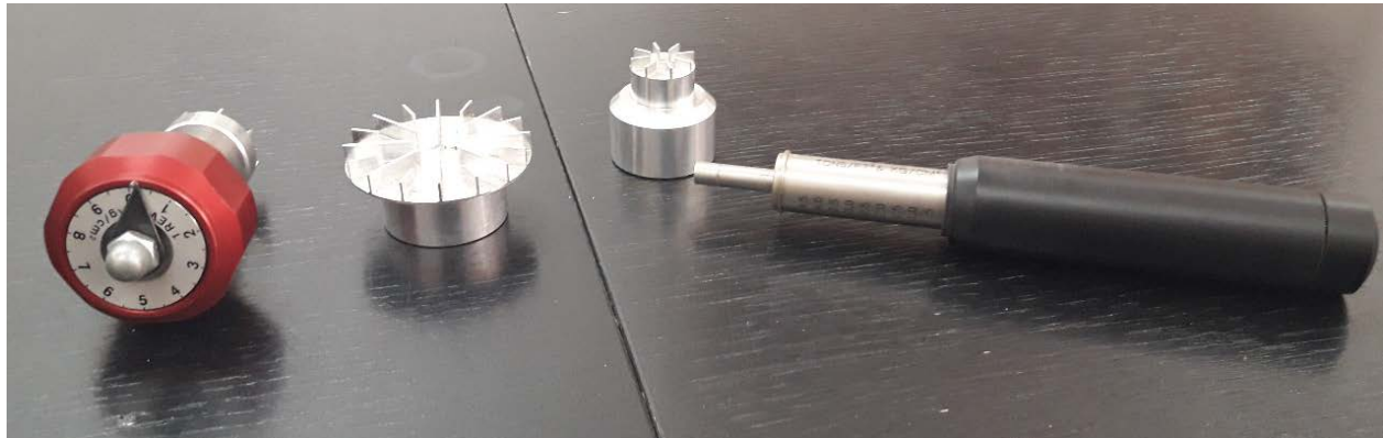
Слика 2. Апаратура за одређивање механичких особина земљишта (фото: Живановић)
